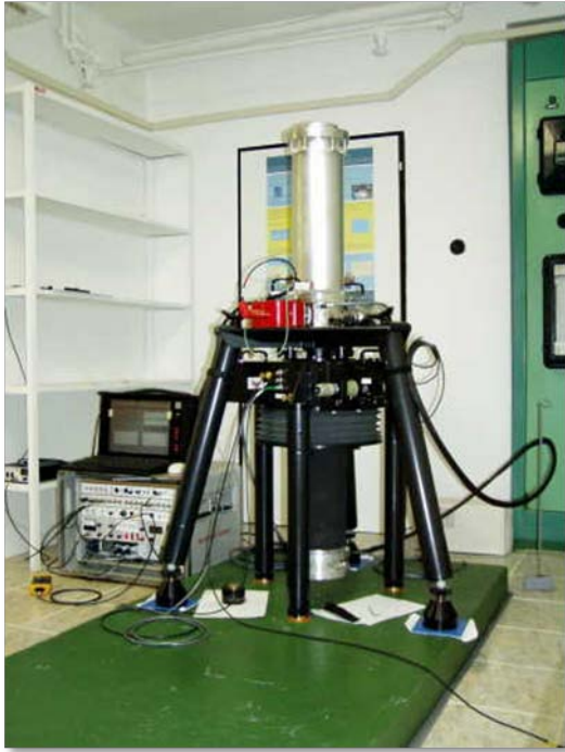
Absolutní gravimetr FG5 No. 215 (vlevo) a supravodivý gravimetr OSG-050 (vpravo)
