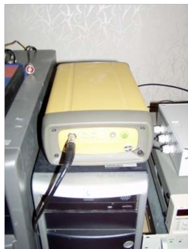
GNSS přijímač Topcon NetG3 s anténou Topcon CR-G3 na stanici GO Pecný
